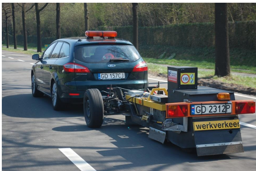
figuur 3 De driewielige rolweerstandstrailer van de TU Gdansk meet de rolweerstand van een personenautoband. De twee voorwielen zijn steunwielen. Het achterwiel is het meetwiel en zit onder een windkap. (foto: M+P tijdens één van de meetcampagnes in Nederland)
