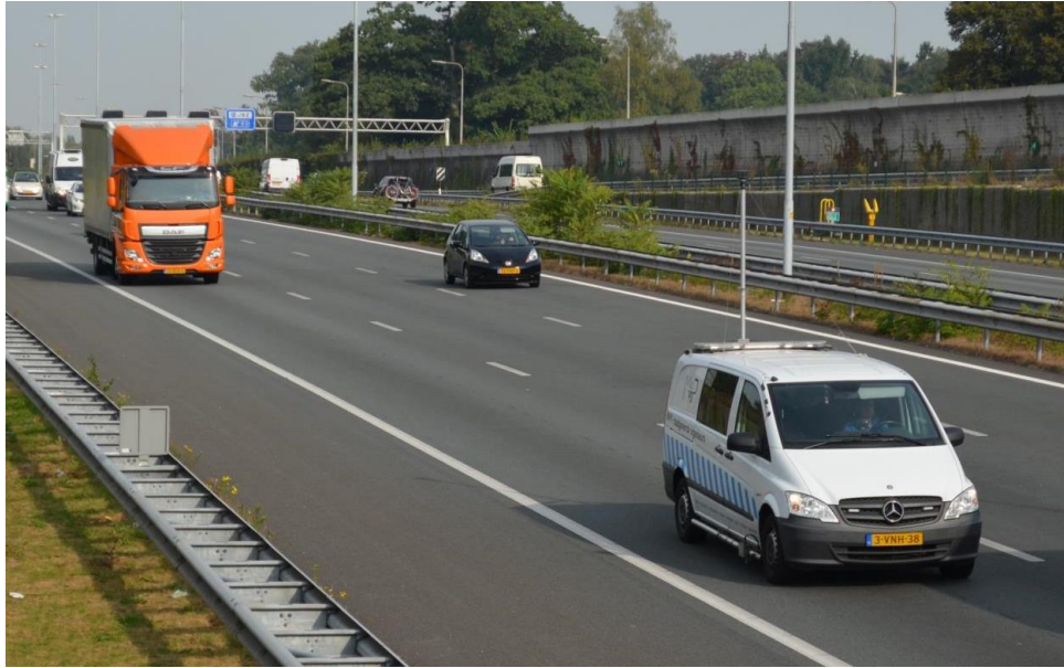
figuur 5 De twee meetvoertuigen in actie op de snelweg. Op de voorgrond de bestelwagen met o.a. de windmeter en textuurmeter. Op de achtergrond de vrachtwagen waarvan het brandstofverbruik wordt gemeten.
